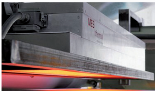
Trocknen von Beschichtungen auf Geweben
